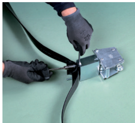
Установка буксирующей тележки RG3506.
